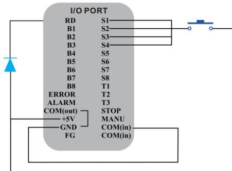
PLC 控制接线方式
